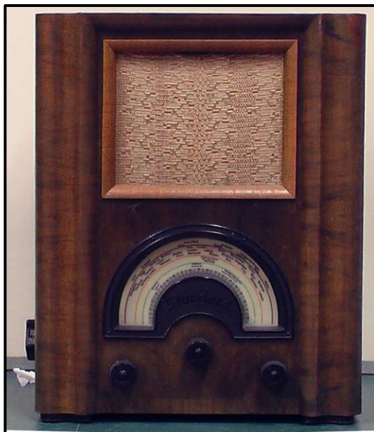
Radiomottagare vanlig på 1930-talet med LV, MV, 5 rör och högtalare. Foto: Kjell Ågren
