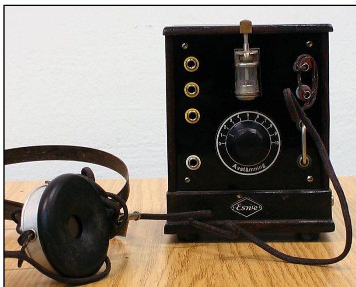
Kristallmottagare fabrikat Eswe. 1920-tal. Använd av Hjalmar Falk från Kiruna. Foto; Kjell Ågren
